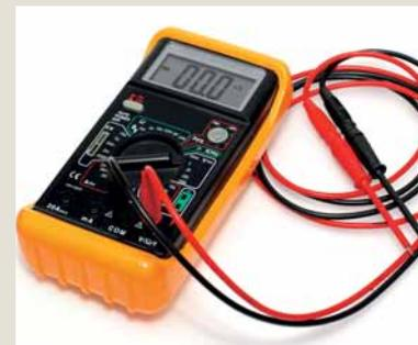
» Мультиметры бывают всяких форм и размеров, но большинство использует круговой переключатель для выбора функции и цифровой дисплей для отображения информации.
