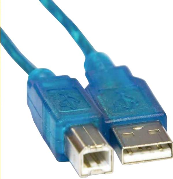
» Кабель USB с разъемами типа 2 (слева) и 1 (справа) нужен для соединения Arduino с вашим ПК.
